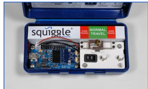
MC-3300-RV 制御回路：NSD-2101 ドライバー IC、New Scale Pathway™ 制御ソフトウェア、と組み合わせると、モーター評価、駆動方式評価が容易に行えます。
