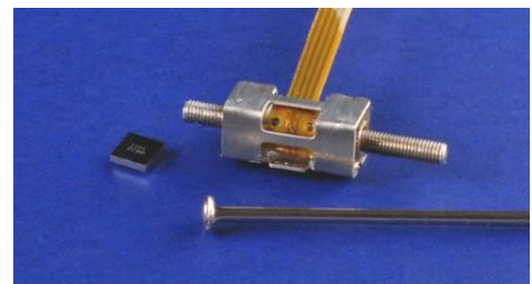
SQL-RV SQUIGGLE モーターと NSD-2101 ドライバー IC (比較用虫ピン)
